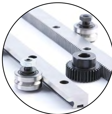
Напрямні HerpoMotion для роботи в забрудненому середовищі. V-подібна рейка та ролики із самоочисним ефектом видаляють пил та бетонний абразив, не допускаючи їх потрапляння в зону кочення.
